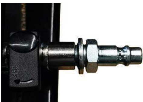
Rys. 16: Zamontowane złącze sprężonego powietrza
